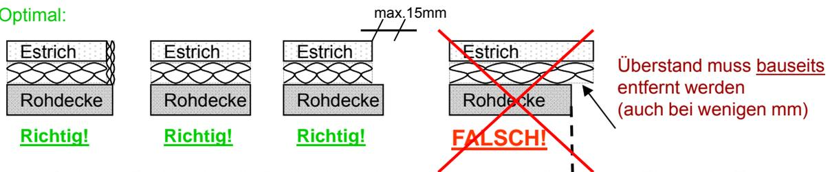
Hinweis: Steht der Estrich über die Deckenkante hinaus, müssen wir diesem zum Einbau der Treppe entfernen und den Mehraufwand berechnen.
